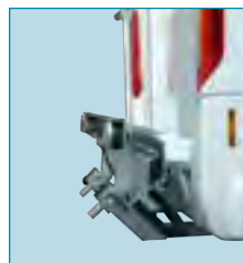
Fahrzeug mit hochgeklapptem Träger ca. 40 cm kürzer
